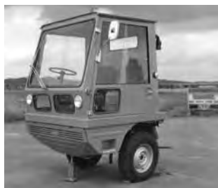
Triebkopf, bestehend aus Vorderachse mit davor liegendem Antriebsaggregat und aufgesetztem Führerhaus. Im Hintergrund ist ein abgekoppelter Nachläufer zu sehen. Foto: Archiv Dr. Rudolf
