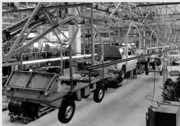
Produktionslinie des Haflingers Anfang der 70er: Im Hintergrund wird auch bereits der Pinzgauer gefertigt. Haflinger und Puch 500 laufen zu dieser Zeit schon auf einem gemeinsamen Band. Foto: Johann-Puch-Museum Graz.
