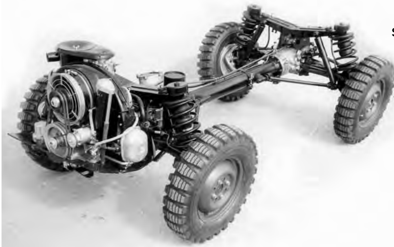
Das Zentralrohrfahrgestell mit den Portalpendelachsen. Der Motor ist am Heck fliegend angeflanscht, das Getriebe befindet sich in einem gemeinsamen Gehäuse mit dem Hinterachsdifferential. Foto: Archiv Dr. Rudolf
