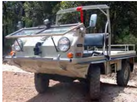
Innen: US-Ausführung „Pathfinder“, Bj. 1971, mit 7 inch Sealed-Beam-Scheinwerfern. Alle Leuchten, darunter auch die Seitenmarkierungsleuchten, stammen von der englischen Fa. Lucas. Daneben: Einer jener US-Haflinger, die man nach Australien auslieferte und zu Rechtslenkern umrüstete. Das abgebildete Fahrzeug wurde zusätzlich noch mit dem Tropen-Zyklonluftfilter auf der Front ausgestattet.
