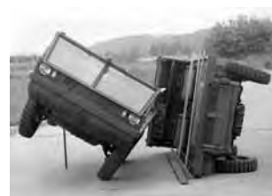
Rücken-an-Rücken-Verladung von Haflingern - so konnten diese in Folge lufttransportiert und mit Fallschirmen abgeworfen werden. Dies wurde zu Erprobungszwecken von der Deutschen Bundeswehr durchgeführt. Foto: Archiv Dr. Rudolf
