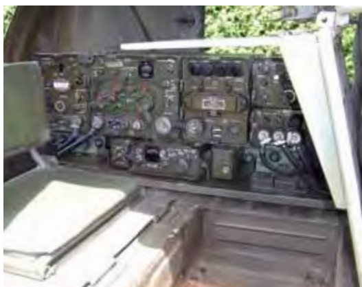
Funk-Haflinger mit Zwischenwand hinter den Vordersitzen und Antennensockeln am Dach. Der optionale Nebenantrieb kam bei diesen Fahrzeugen zum Einsatz: Die Funkbatterie wurde mit Hilfe einer zusätzlichen, am Tragrohr angebrachten Lichtmaschine aufgeladen. Rechts: Funk-Haflinger innen - rechts der Arbeitsplatz des Funkers mit Klappstisch, links die Funkeinrichtung statt des zweiten rückwärtigen Sitzes. Rechts innen: Haflinger in der Ausführung für Mannschafts- und Materialtransport beim Österreichischen Bundesheer.
