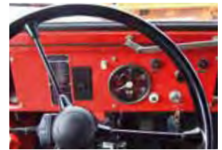
Rechte Spalte, v. o.: Die „Waffen“ des Haflingers: Schalthebel für Allradantrieb (grün) und Differentialsperren vorne und hinten (gelb). Spartanisches Armaturenbrett (Mitte): Tacho, Öl- und Ladekontrollleuchte sind die wichtigsten Instrumente des Haflingerfahrers. Bei späteren Versionen (unten) wie dieser gab es auch eine Benzinstandsanzeige (in der Regel allerdings nur eine Tankreserve-Warnleuchte).
