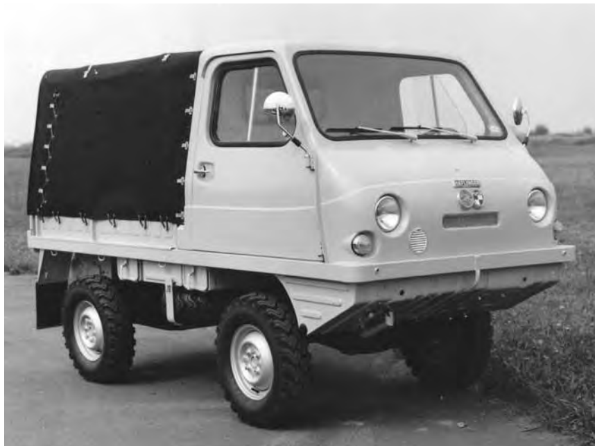
Typ 700 LP: Steyr-Puch Landwagen, der Universaltransporter für Straße, Feldwege und Gelände – es blieb bei wenigen Prototypen. 700 AP: Das Polyesterfahrerhaus für den Haflinger setzte sich durch und kam in Folge bei vielen zivilen Ausführungen zum Einsatz. Rechts: Haflinger der zweiten Serie mit Polyesterfahrerhaus und zugehörigem Verdeck ohne hintere Türen. Alle Bilder: Archiv Dr. Rudolf
