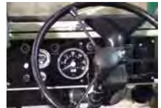
Rechte Spalte, v. o.: Die „Waffen“ des Haflingers: Schalthebel für Allradantrieb (grün) und Differentialsperren vorne und hinten (gelb). Spartanisches Armaturenbrett (Mitte): Tacho, Öl- und Ladekontrollleuchte sind die wichtigsten Instrumente des Haflingerfahrers. Bei späteren Versionen (unten) wie dieser gab es auch eine Benzinstandsanzeige (in der Regel allerdings nur eine Tankreserve-Warnleuchte).
