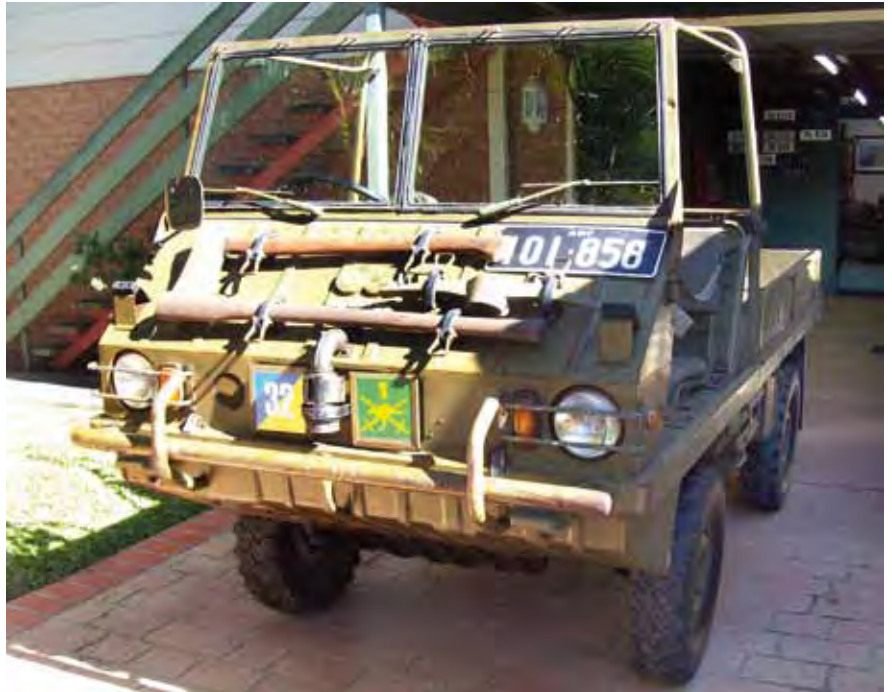
Australischer Armeehaflinger, Baujahr 1966, Tropenausführung. Besonders auffällig: Halterungen für Schanzzeug sowie taktische Zeichen auf der Front. Foto: Peter Derges
